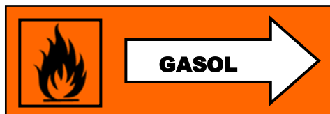
Rörledningsmärkning med farosymbol
