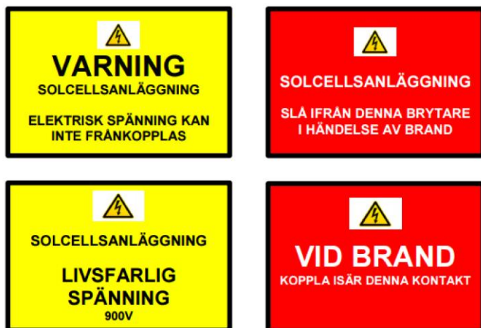
Figur 2: Exempel på skyltning i byggnaden, de två röda är för räddningstjänsten.
